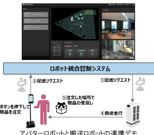
アバターロボットと搬送ロボットの連携デモ
