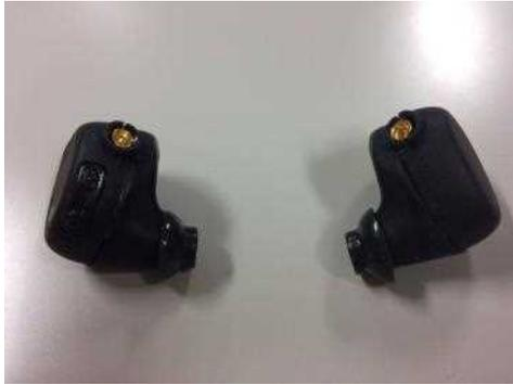
マイクとスピーカに加え、顔の向き・姿勢・移動情報などの常時検出が可能な9軸モーションセンサを搭載した、イヤホン型端末のプロトタイプです。各種センサから取得した情報による耳音響認証技術による本人の特定や、地磁気による屋内位置測位ができます。「Haneda Robotics Lab」では、羽田空港の職員が本端末を装着。
