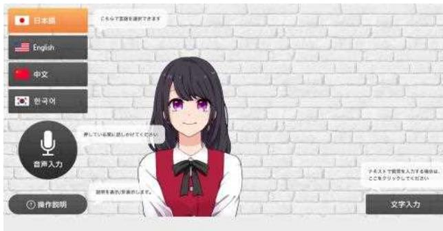
音声とテキストでユーザーからの質問に回答する人工知能（AI）接客システムです。音声認識・音声合成技術、アニメーションと自然言語技術の連動により、人に近い自然な動きを実現。正答率は7割
