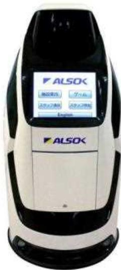
自律走行方式の警備・案内ロボットです。警備や案内を効率化するだけでなく、アトラクション用途など新たな活用を重ね、全国で9台が導入されています。安全を最優先にした設計で、人や障害物に接近した場合に自動停止する衝突回避機能により、2015年の販売開始から無事故の実績があります。「Haneda Robotics Lab」では、空港のような広大な空間での見回り、侵入者の検知などの警備機能について検証します。
