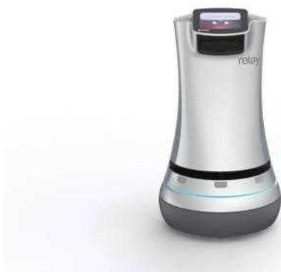
人から人へモノを運ぶ、自律走行型デリバリーロボットです。各種センサーを搭載し、自動で障害物を避けて目的地まで自律搬送します。人通りが多い場所でも最適なルートを選択し「かしこく」「安全に」「確実に」届けます。「Haneda Robotics Lab」では、お客様におみやげ・グッズなどを Relay がお届けすることをめざします。また、空港のような様々な国籍、性別、年
