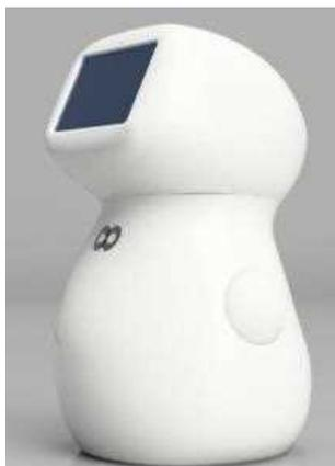
カメラと自走機能を備えた、AI との会話も楽しめるスマートロボットです。遠隔地からスマートフォンアプリを介して、ボタンや音声での操作が可能です。「Haneda Robotics Lab」では、これらの機能を活かし、多言語でのお客様のご案内や、遠隔地からのオペレーター接続実験などを行いながら、AI 会話の音声認識率向上のためのデータ収集を行います。
