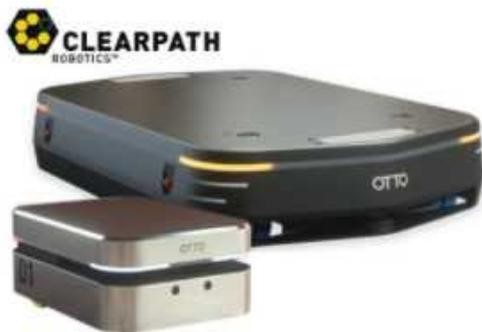
レーザーセンサーを利用し、床にマーカ一等を敷設することなく施設内を走行できる自律型搬送ロボットです。「OTTO 100」は最大100Kgまでの段ボール箱・コンテナボックス・収納箱などの荷物を、人間に代わって搬送します。また、「OTTO 1500」はパレットやコンベア、リフターなどの拡張機能を備え、重量物運搬も可能。「Haneda Robotics Lab」では、
