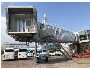
本素材施工済の PBB ※室内温度の 13%低下確認済
