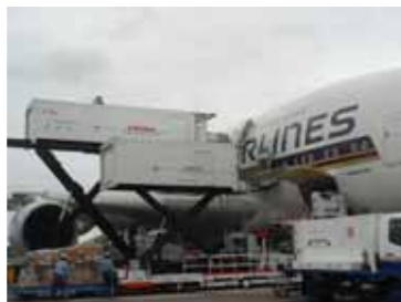
A380に機内食を搭載するフードサービストラック (2008年5月20日成田国際空港)
